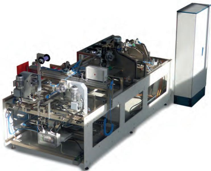
Macchina automatica per la produzione di cartelle con elastico piatto incrociato e fissato da occhielli in metallo.
