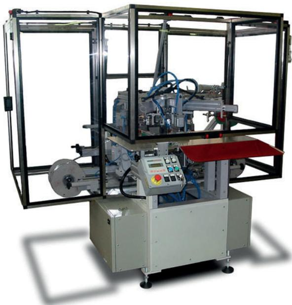
Unità semi-automatica per la produzione di cartelle con elastico tondo incrociato e dritto dotato di capicorda metallici arrotondati.
