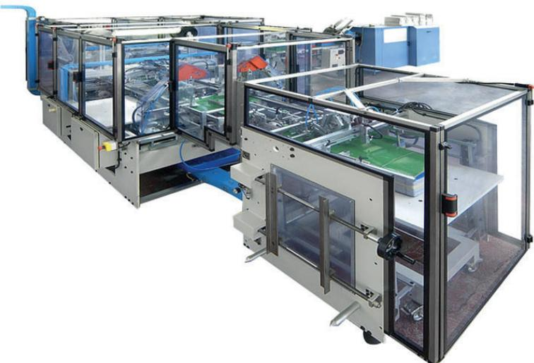
Macchina automatica per la produzione di cartelle con elastico tondo incrociato dotato di capicorda arrotondati.
