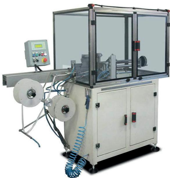
Unita' elettro-pneumatica per l'applicazione di 2 terminali metallici arrotondati su elastici, cordoni e nastri fino a 40 mm di larghezza.
