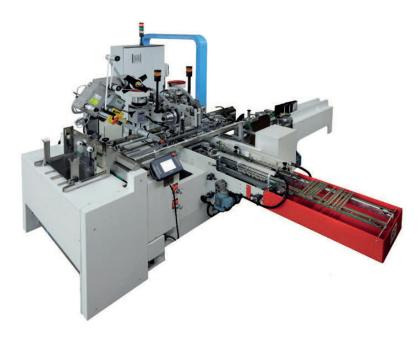
Linea automatica per applicare etichette autoadesive (da rotolo) e rivettare meccanismi ad anello su plance termo-saldate Automatismo ad elevata capacità produttiva.
