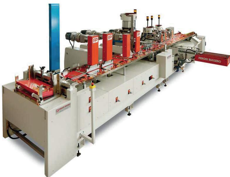
Macchina automatica per cordonare (2 cordonature), applicare un occhiello dito e meccanismi ad anello (anche con terzo rivetto)
