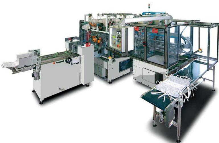
Linea automatica per la produzione di faldoni con 6 fettucce fissate tramite occhielli di metallo, completa di unità di cordonatura place.
