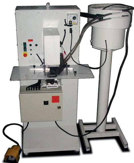
Macchina manuale a motore per l'applicazione di nr. 01 Occhiello Dito – Posizionamento manuale della plancia – Preforo e applicazione senza spostare il cartone. Alimentazione degli occhielli da vibratore.
