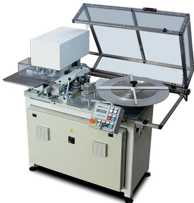
Macchina semi-automatica per applicazione di rinforzi metallici angolari su classificatori a leva (1 angolo per ciclo)
