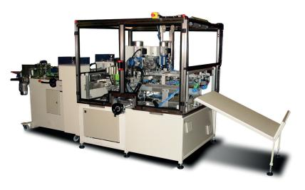
Linea automatica per cordonare, applicare due patelle laterali e fissare una banda elastica piatta larga 15 mm.
